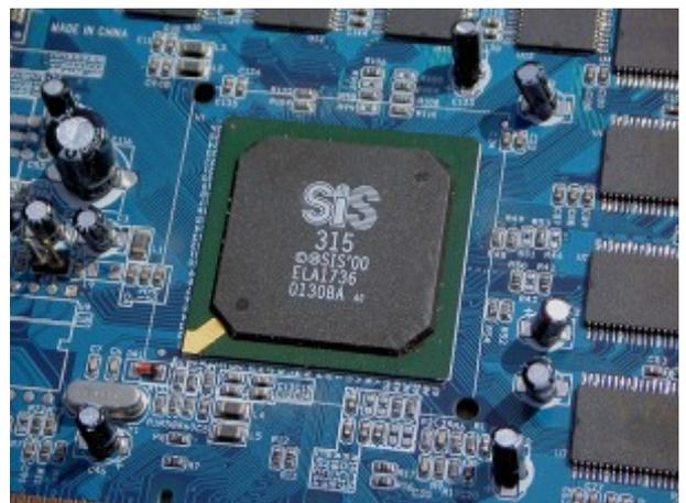
Fig.33- Microprocesseur inséré dans son circuit électronique. Merci à Wikipedia
