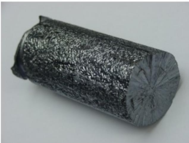
Fig.32- Barreau de silicium polycristallin, destiné à la production de silicium monocristallin (longueur 10,3 cm, diamètre 4 cm).
