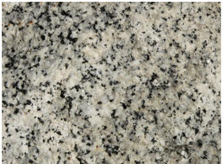
*Fig.28- Surface de granite. Son nom vient de sa structure en grains, bien visibles à l'œil nu: quartz, mica et feldspaths. Merci à Wikimedia*
