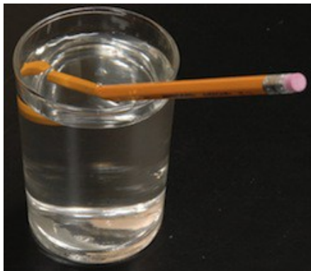
Dans l'eau, le bâton paraît brisé en deux, à cause de la réfraction de la lumière. Merci à Shortdrusilla38
